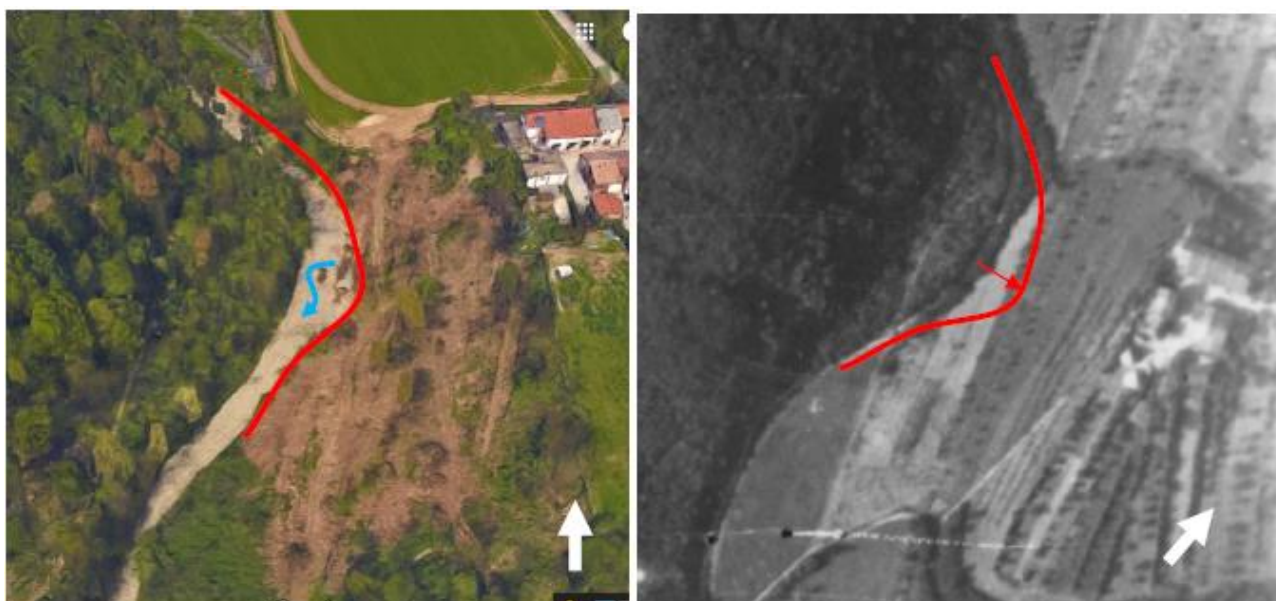
Figura 54: argine sinistro in erosione, in località C.na Campaccio. (Sinistra ortofoto Google 2016, destra foto aerea IGM 1936)
